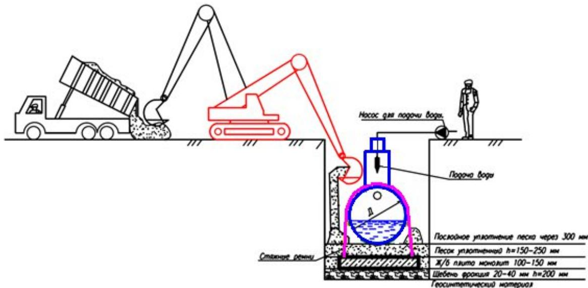
**ВНИМАНИЕ. Одновременно с обратной засыпкой необходимо производить наполнение емкостей BAZMAN водой для предотвращения её всплытия, выдавливания и смещения.**
