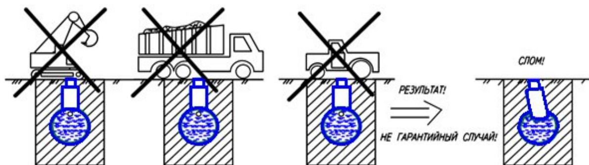
**Запрещается движение автотранспорта и тяжелой строительной техники после обратной засыпки котлована с установленным в нем емкостями BAZMAN в избежание повреждений.**
