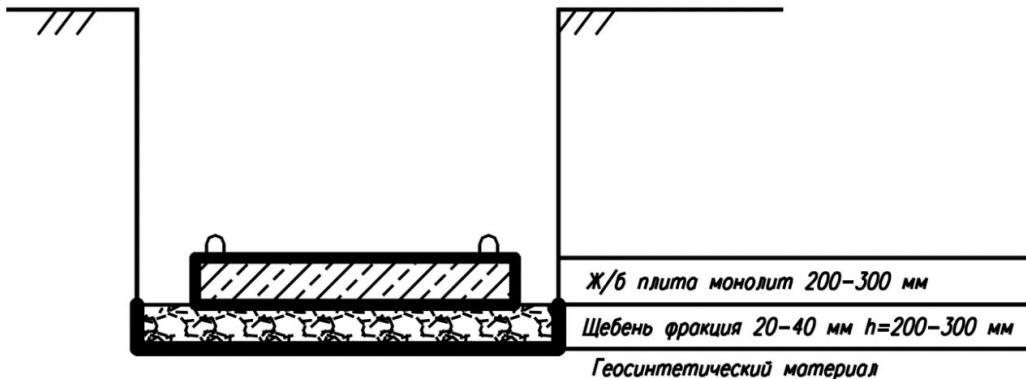
**Вариант №2.** При изготовлении ж/б плиты на дне котлована в качестве основания рекомендуется использовать уплотненный песок и бетонную подготовку.
