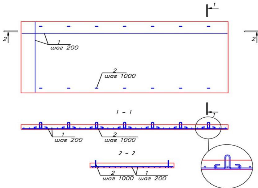
Узел деталировки закладной детали (проушина для крепления стяжных ремней)
