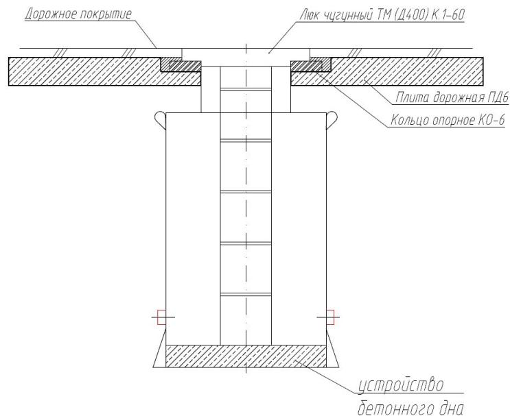
При установке емкостей BAZMAN в обводненных грунтах, при не достаточной высоте обратной засыпки или расположении в низинах и т. д. могут быть использованы следующая схема устройства пригруза,, предотвращающие вскрытие.
