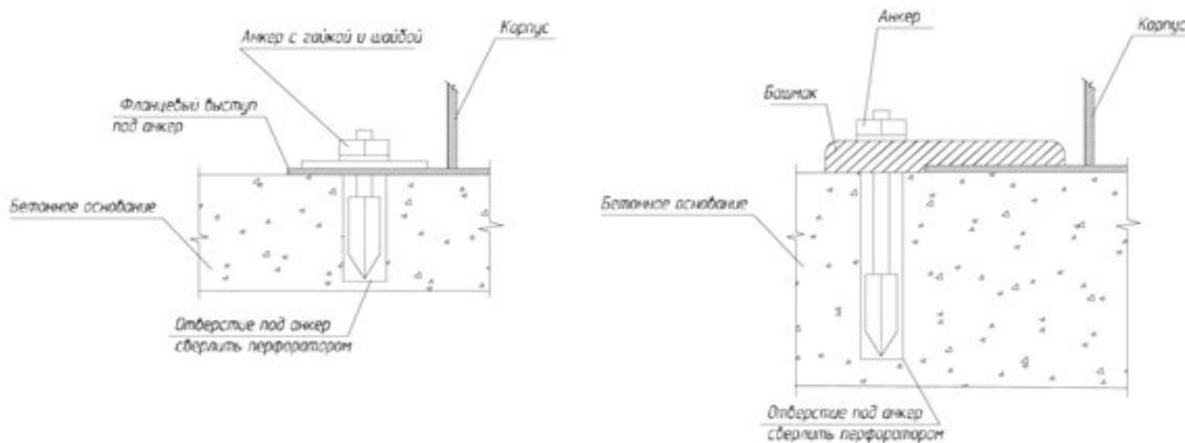
Если емкость диаметром более 1,9 метра, или сложные условия установки (высокий уровень грунтовых вод, большая глубина установки), **то необходимо дополнительно к анкерам произвести пригруз корпуса бетонным раствором**. При этом, верхний уровень бетона должен быть на 200 мм выше первого ребра жесткости корпуса.
