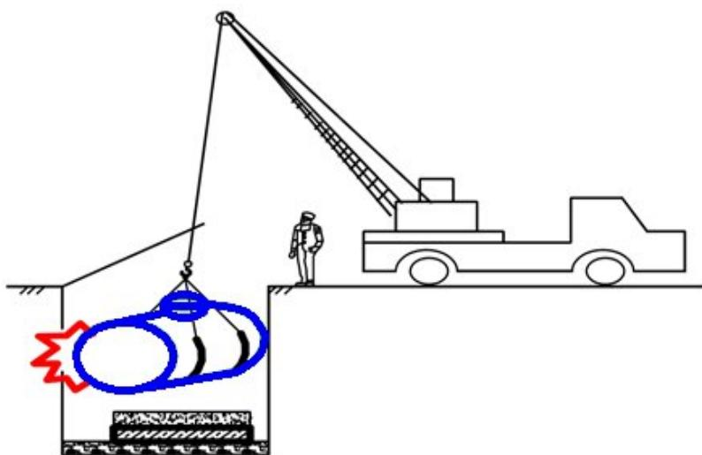
При перерывах в монтаже емкостей необходимо зафиксировать емкости от смещения и всплытия (путем наполнения водой) прикрыть открытые горловины временными заглушками исключающими попадания внутрь емкостей грязи или посторонних предметов.
