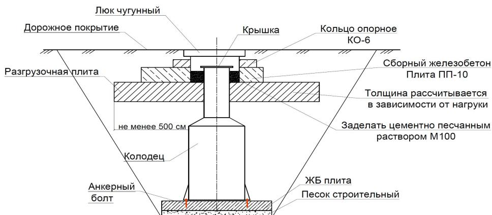
Колодцы и емкости (резервуары) из полимерных материалов необходимо монтировать на уплотненное песчаное либо монолитное железобетонное основание. В зеленой зоне, в сухих грунтах толщина песчаного основания должна быть не менее 250 мм для емкостей и не менее 150 мм для колодцев. Степень уплотнения песчаного основания должна быть не ниже 0,95.
