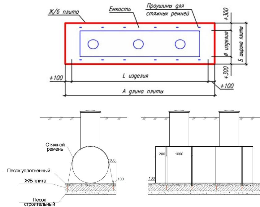
Для армирования плиты рекомендуем использовать арматуру класс AIII диаметром Ø12 мм с шагом 200Х200 мм. При изготовлении плиты внизу котлована достаточно армирования в одну сетку. При изготовлении плиты на бровки котлована рекомендуем армировать в две сетки в избежание поломки плиты при монтаже краном. В качестве закладных деталей (проушин для крепления стяжных ремней) использовать арматуру класс AI диаметром Ø16 мм.
