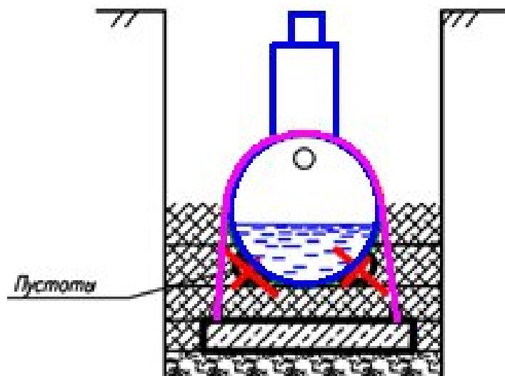
В качестве материала обратной засыпки применяется строительный песок. При использовании песка не допускается наличия в нем крупных валунов размером более 50 мм, глинистых комков, строительного мусора и т.д.
